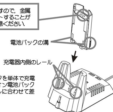
リチウムイオン電池/パックを単体で充電するとき、リチウムイオン電池/パックの溝を充電器内側のレールに合わせて差し込みます
